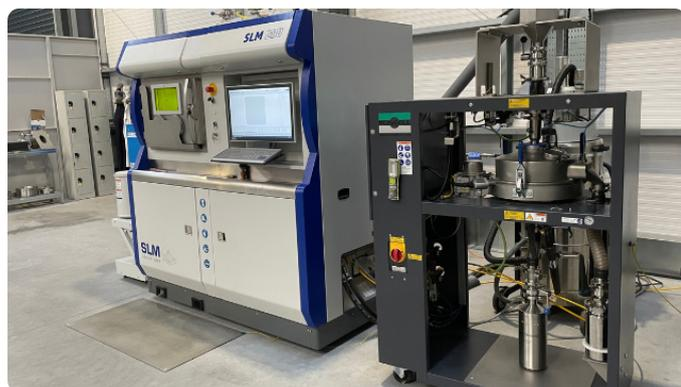
AMPro® Lite 配套 SLM280 打印机
