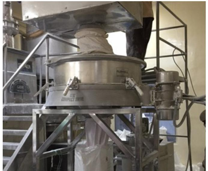
图1. 安装在Sri Krishna药业乌帕尔工厂用于筛选药粉的Russell Compact Sieve® 紧凑型振动筛
