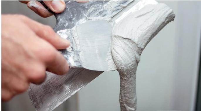
最粗的石灰膏 (>50微米) 被用于制作石灰砂浆，次粗的石灰膏 (15-50微米) 被用于制作石灰泥，而细石灰膏 (<15微米) 则被用于制作石灰涂料。
