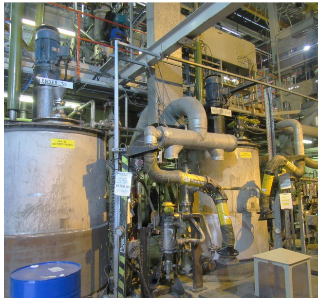
图2. Lucite 的elf-Cleaning Russell Eco Filter®自清洁式过滤器被用于从制作外科石膏的粘胶树脂中去除附聚物
