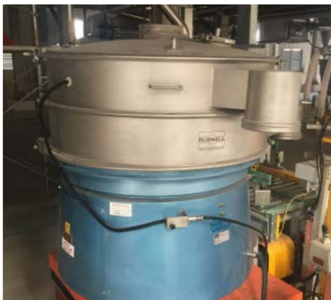
图1-这家领先的涂料公司在中国的工厂内安装的 Finex Separator™ 分级筛
