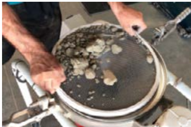
图2. Paleo Solutions 使用Russell Mini Sifter™迷你振动筛作为干筛分装置
