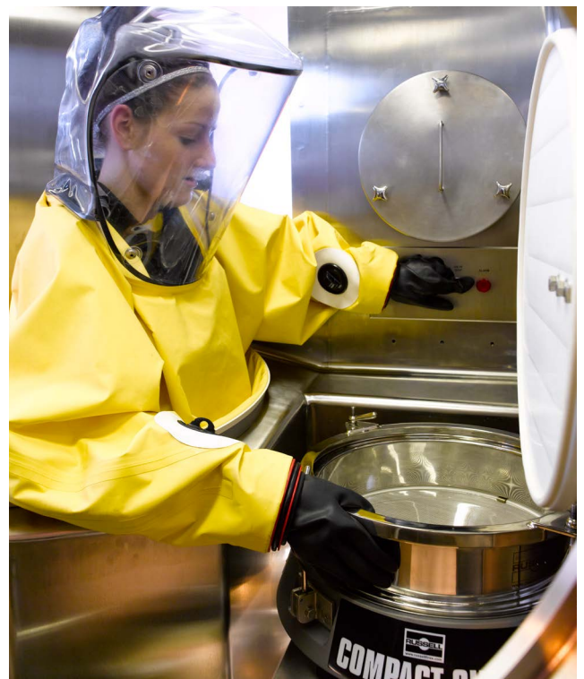
图1-高密闭性隔离器中安装的Russell Compact Sieve®紧凑型振动筛
