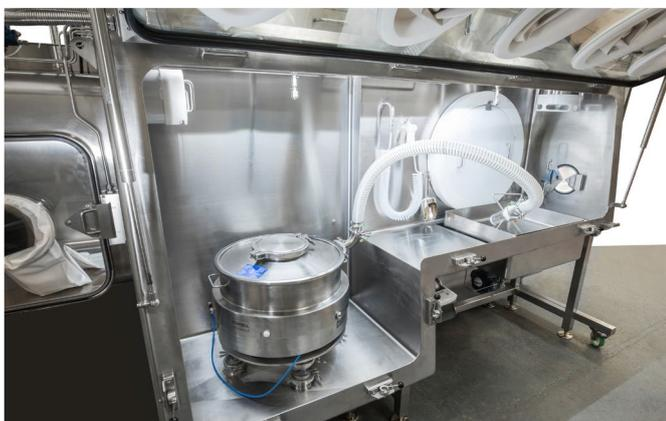
图2. Howorth 高密闭性隔离器内安装的带Russell Compact Airlock Sieve™ 紧凑型气锁振动筛夹紧系统的Russell Compact Airswept Sieve™ 紧凑型气扫振动筛。
