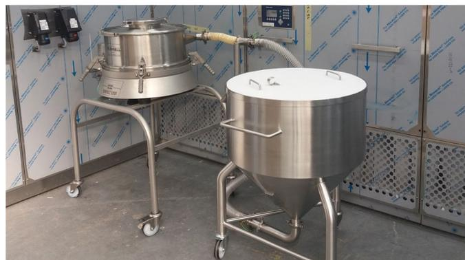
图3. 安装在Howorth的WORKSAFETM密闭罩内的Russell Compact Airswept Sieve™ 紧凑型气扫振动筛
