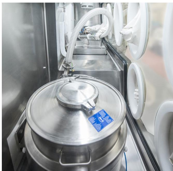
图1. Russell Compact Airswept Sieve™ 紧凑型气扫振动筛被轻松地整合在密闭隔离器内。
