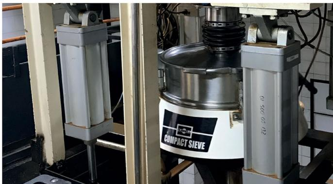
用于替代金属探测器而安装的Russell Compact Sieve®紧凑型振动筛占地面积小于2平方米。其振动筛分使Realcafé能够将包括金属和非金属物质在内的更多种类的污染物从生产过程中去除；从而显著提高其产品的纯度和质量。
