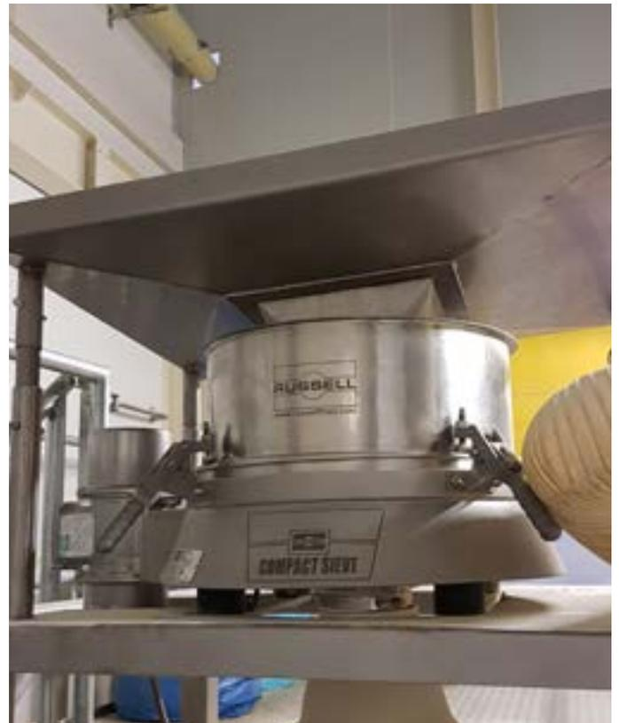
Figure 1. 安装在Lactoprot公司位于吕贝克市工厂的Russell Compact Sieve®紧凑型振动筛
