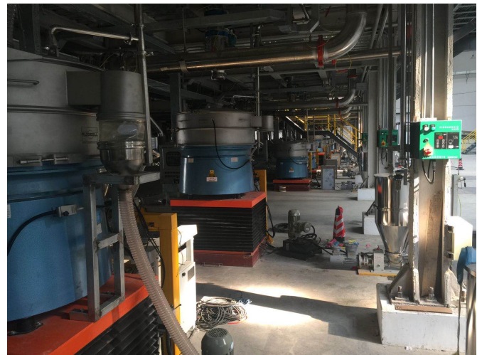
图2：在阿克苏诺贝尔工厂的生产线中将 Vibrasonic® Deblinding System 超声波防堵塞系统配合Finex Separator™强力振筛相结合
