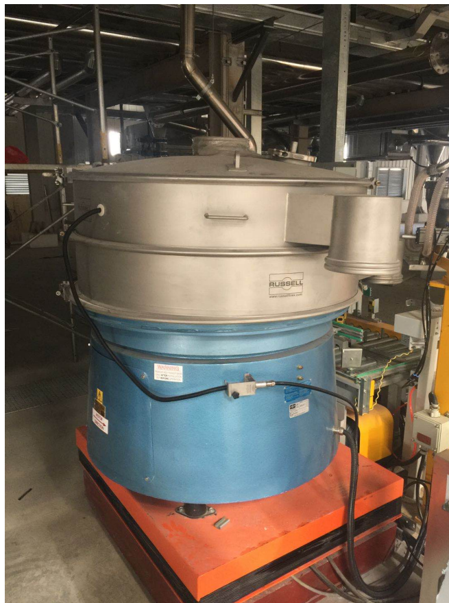
图3：安装在阿克苏诺贝尔工厂的生产线中的Finex Separator™强力振动筛
