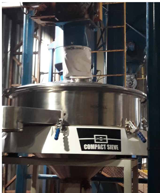
图1. Russell Compact Sieve® 紧凑型振筛在IBC车间工作，筛分剔除杂质异物
