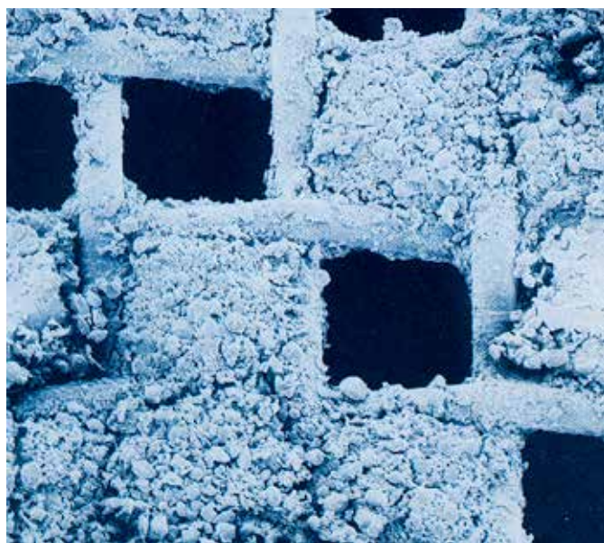
图4：在典型的筛分作业中，颗粒常常聚集在一起堵塞不锈钢丝网。Ultrasonic deblinding systems（超声波防堵塞系统）可以解决这一问题。（资料来源：G. Bopp有限公司）
