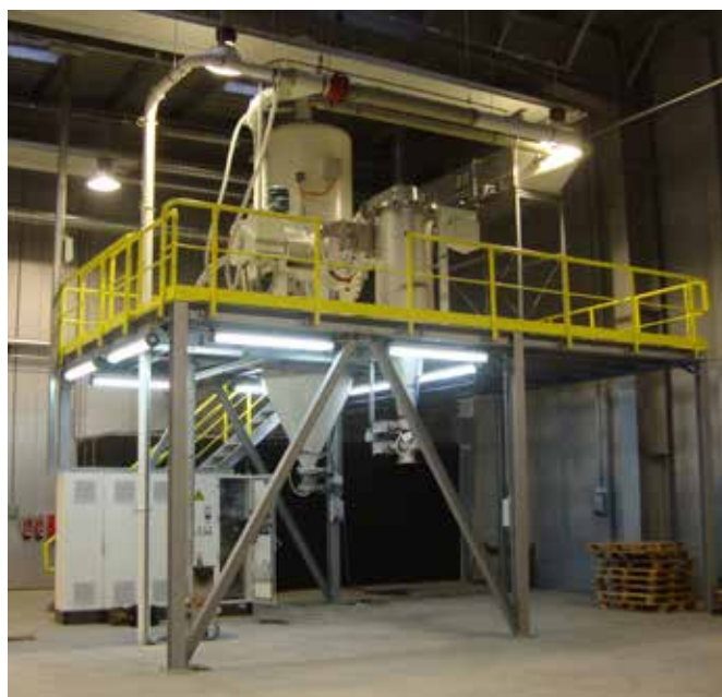
图2：是由Neuman和Esser提供的典型的安装，其筛分作业通常位于灌装线前方的旋风分离器的下方。
