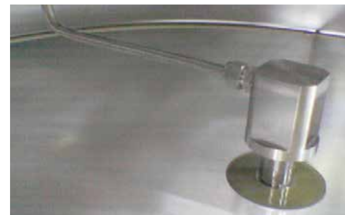
图5：ATEX认证的Vibrasonic® probe（Vibrasonic®超声波探头）经认证可用于区域0、2、2、0、1和2，并可安装在所有Russell振动筛上。
